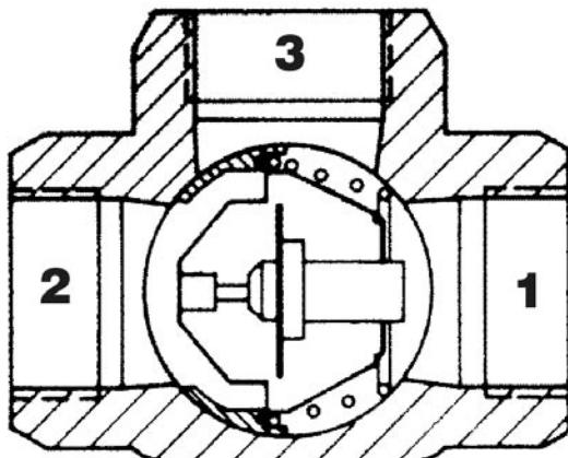
**Рекомендованный размер терморегулирующего клапана TV 60°C**
