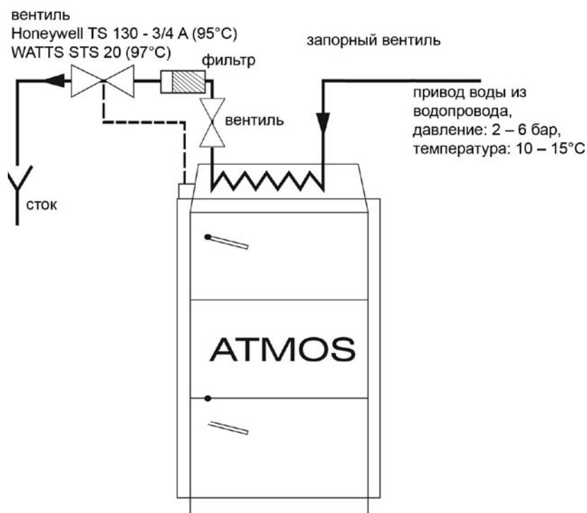
Предохранительный вентиль 6-10 бар
