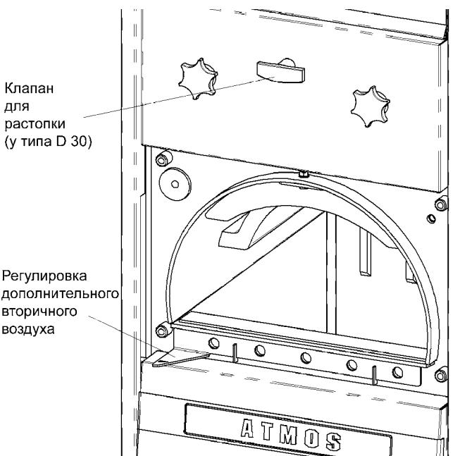
тором тяги тип Honeywell. У котла D30 открыть клапан для растапления. Приоткрыть дверцы, подождать прибл. 5 сек. и загрузить топливо. Для избежания возникновения излишнего дыма дополнить бункер топливом тогда, когда предыдущая закладка топлива сгорит хотя бы на загруженного объема. После того все приведем в первоначальное состояние.
