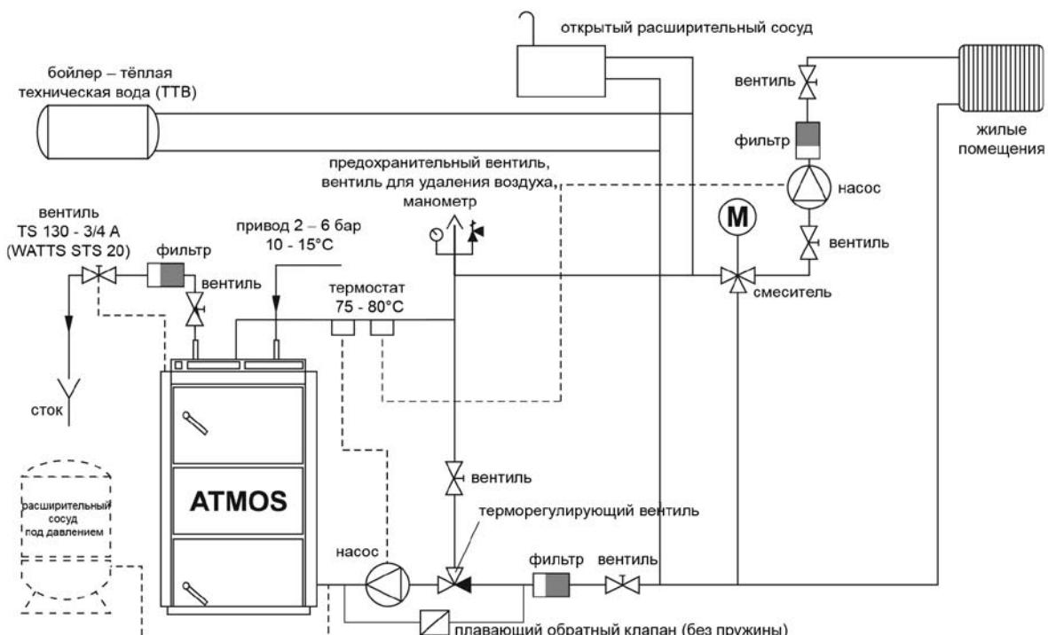
**ВНИМАНИЕ** - при подключении охлаждающего контура против перегреву можно исключить поплавковый обратный клапан на галерее термоклапана и насоса.
