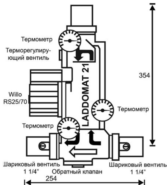
**ВНИМАНИЕ –** Прибор Ладдомат 21 предназначен только для котлов мощностью до 75 кВт вкл. Однако Вам рекомендуем использовать вышеуказанное оборудование только до мощности 50 кВт вкл.
