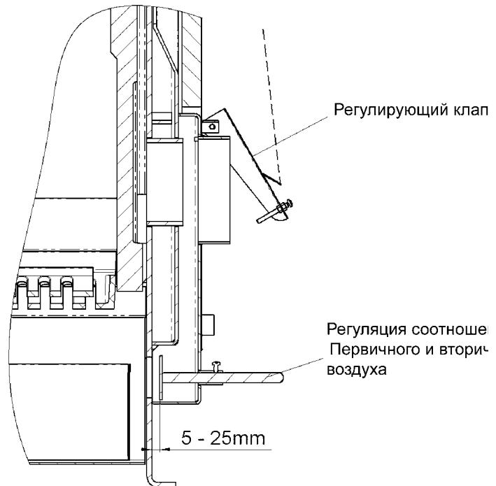
**Оптимальная установка при номинальной мощности :**
